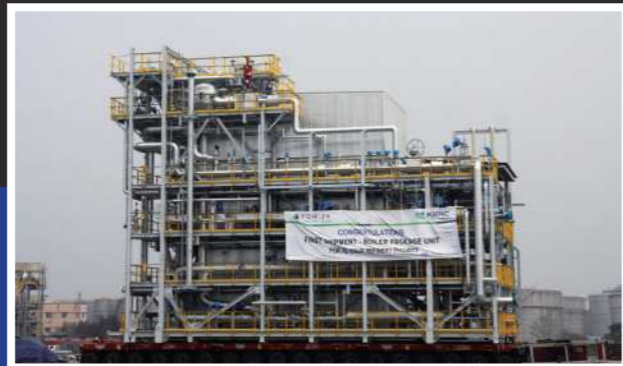
▲SPMT 운송장비에 탑재된 웰크론강원의 산업용 스팀 보일러 모듈
